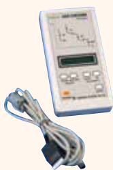
Aferidor de Relé de Proteção
